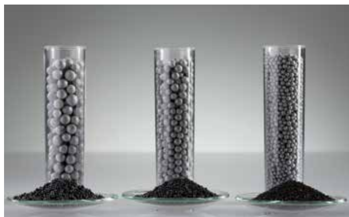
Perle di Neopor®, prima e dopo il processo di espansione
